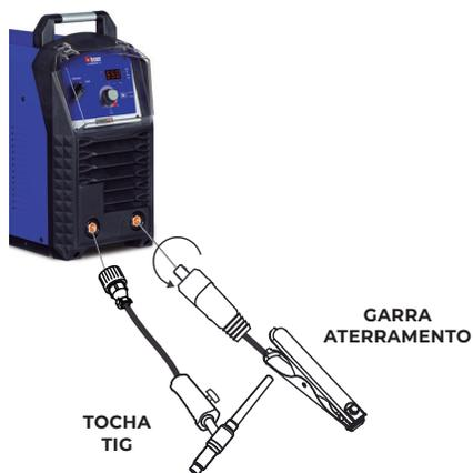
**1** - Conecte a tocha tig ao conector especial da máquina e rosqueie para evitar mau contato.
