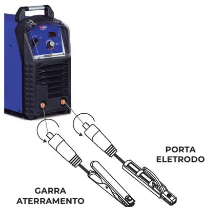
**1** - Conecte o porta eletrodo ao pólo positivo da máquina e tenha certeza de que ao girar o mesmo esteja bem fixado. Evite mau contato.
